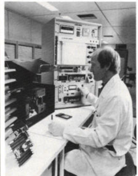
Afb. 13. Met behulp van deze meetopstelling wordt de eindbeproeving uitgevoerd van de laser/glasvezel-combinatie.
