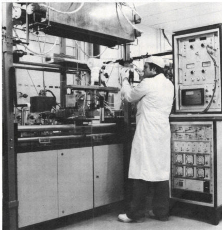
Afb. 10. Het aanbrengen van de laagjes geloteerd materiaal in de holle kwartsbuis tijdens de fabricage van een multimodus vezel met gradiëntprofiel. (Foto Philips.)
