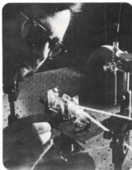
Het afregelen van een optische flipflop.
