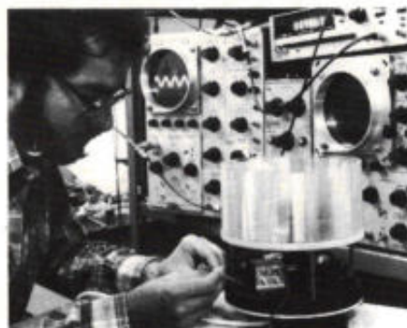
Afb. 5a en b. De glasvezel gyroscoop.
