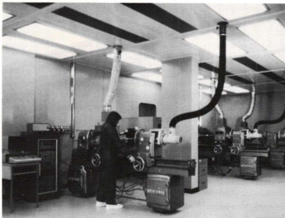
Afb. 3. Overzicht van de produktieruimte waarin een aantal „preform-draaibanken” is opgesteld.
