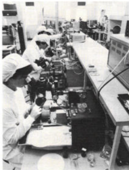
Afb. 10. In een uiterst schone omgeving worden de laserschijfjes op hun drager bevestigd.
