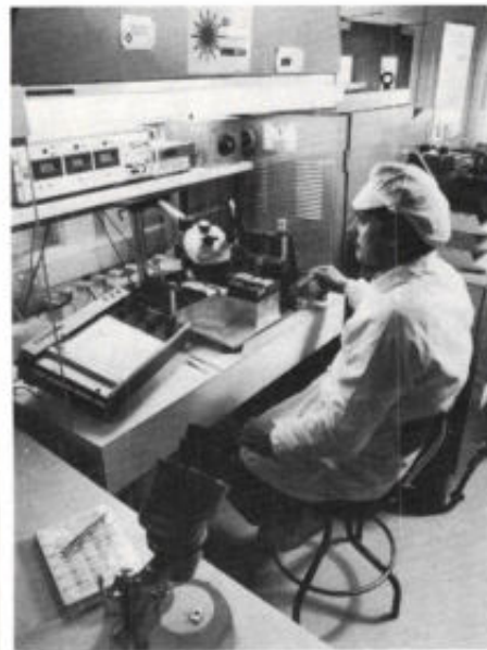
Afb. 11. Het justeren en verzegelen van een stukje glasvezel aan de halfgeleiderlaser.
